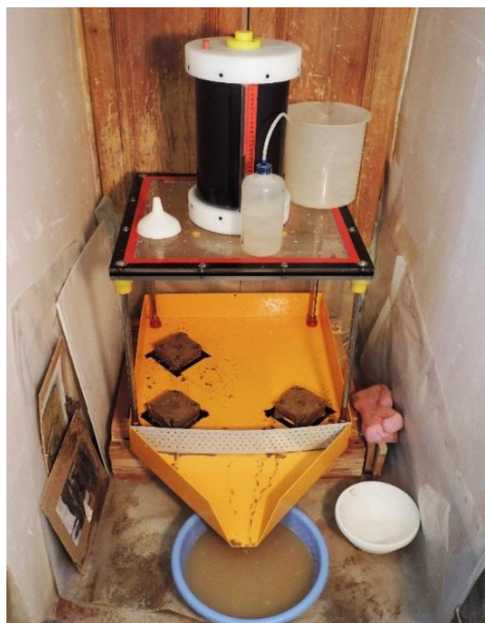
شکل 11. دستگاه شبیه‌ساز باران مورد استفاده برای تعیین میزان فرسایش و دوام نمونه‌های کاهگل تحت بارش مصنوعی Fig.11. Measurement of water erosion of the Kahgel plaster samples by rainfall simulator
