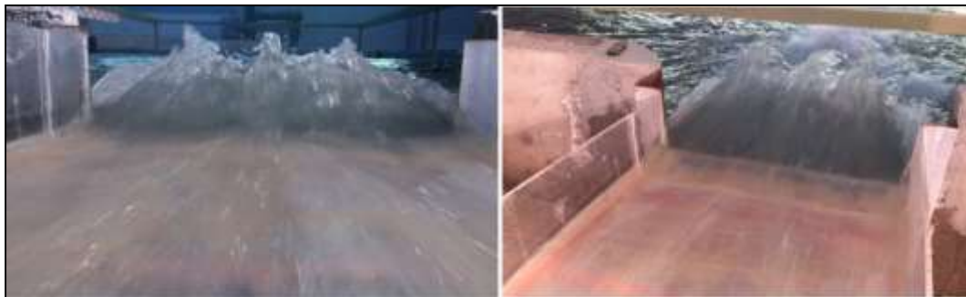
شکل ۵: جت دندانهای حاصل از تداخل امواج بالی شکل روی سرریز
