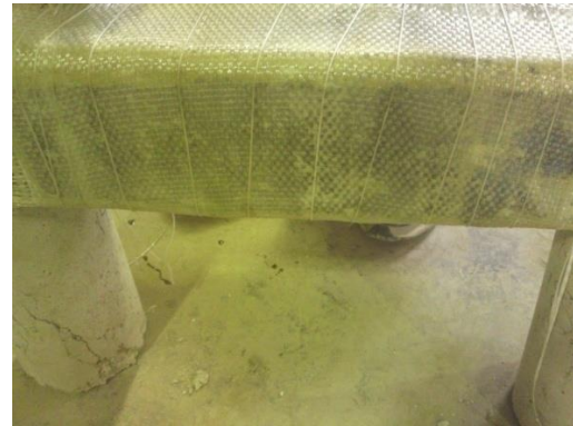
شکل 5. محصور کردن نمونه‌ها توسط GFRP Fig. 5. Confining specimens with GFRP
