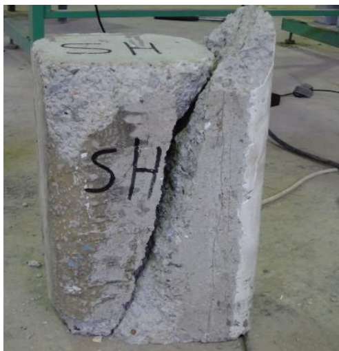
شکل 8. نمونه شاهد با شکست 45 درجه Fig. 8. Control specimen with 45° failure line
