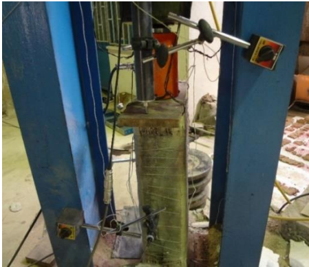
شکل 7. دستگاه بارگذاری و LVDT های عمودی و افقی Fig. 7. Loading device and vertical and horizontal LVDTs
