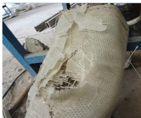
شکل 9. شکست نمونه آزمایشگاهی محصور شده با GFRP Fig. 9. Failure of specimen confined with GFRP
