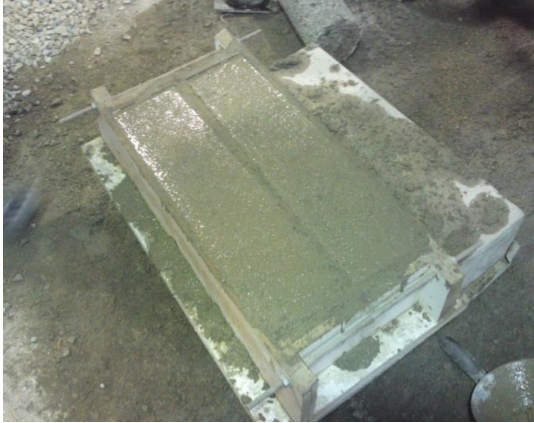
شکل 1. آماده سازی نمونه های بتنی Fig 1. Preparing concrete specimens
