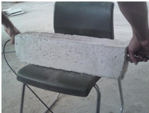
شکل 2. انجام تست اولتراسونیک Fig. 2. Performing ultrasonic test
