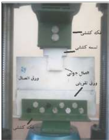
شکل ۲: فک‌های کششی و نمونه ۲ قبل از آزمایش
