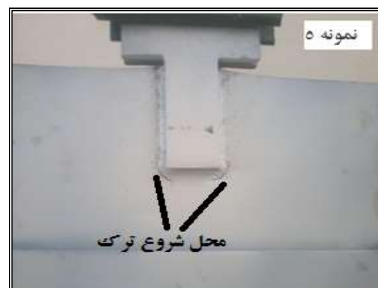
شکل ۶: آغاز شکست با پیدایش یک ترک (نمونه ۱) و دو ترک متقارن (نمونه ۵)
