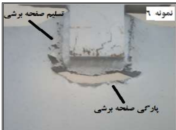
شکل ۷: نمونه‌های ۲ و ۶ در لحظه شکست
