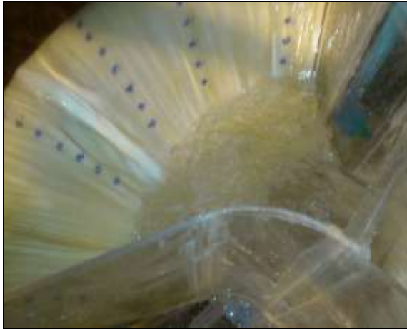
شکل ۱۱: پدیده پرش هیدرولیکی ثابت در پنجه سرریز
