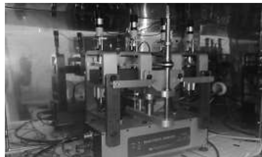
شکل ۳: دستگاه مورد استفاده خستگی ساخت شرکت ELE
