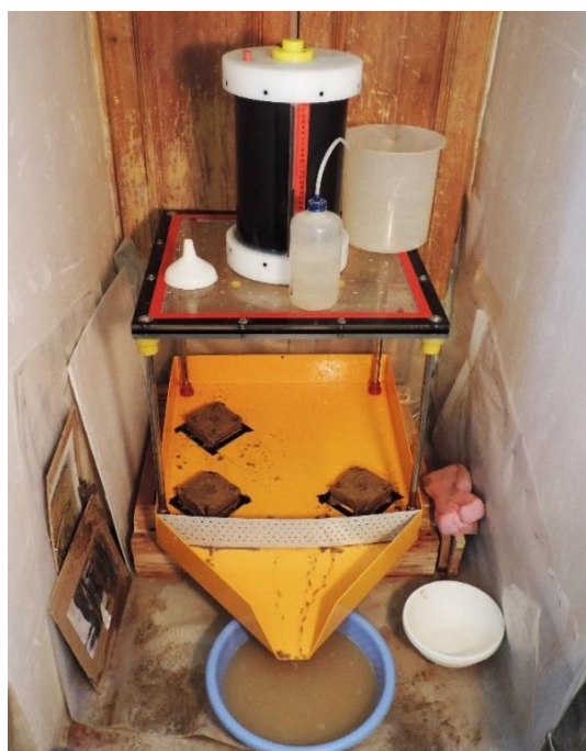
شکل 11. دستگاه شبیه‌ساز باران مورد استفاده برای تعیین میزان فرسایش و دوام نمونه‌های کاهگل تحت بارش مصنوعی
