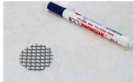
شکل ۲: شکل و اندازه ژئوگرید مصرفی
