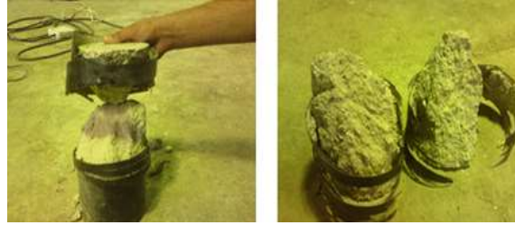
شکل ۱۰: نحوه شکست در نمونه ۸ حفره‌ای که علاوه بر تزریق اپوکسی با الیاف پلیمری نیز محصور گشته است.
