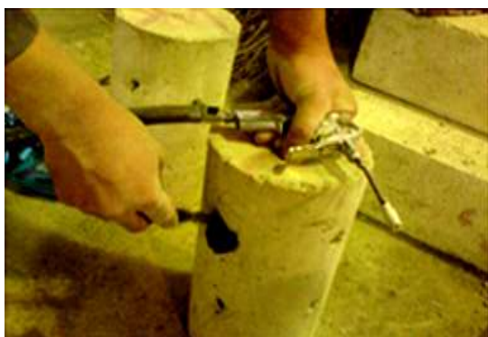
شکل ۴: تمیز کردن سوراخ توسط برس
