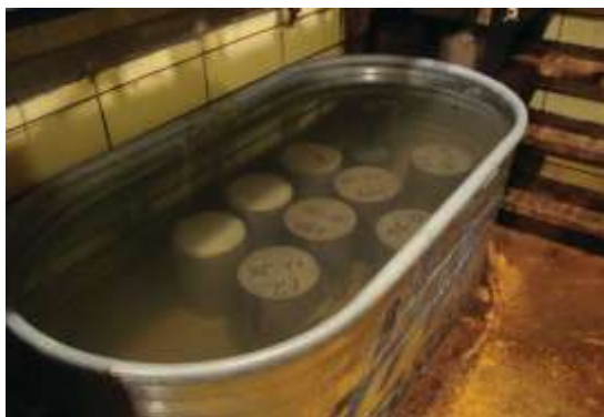
شکل ۱: عمل‌آوری نمونه‌ها به مدت ۲۸ روز در آب
