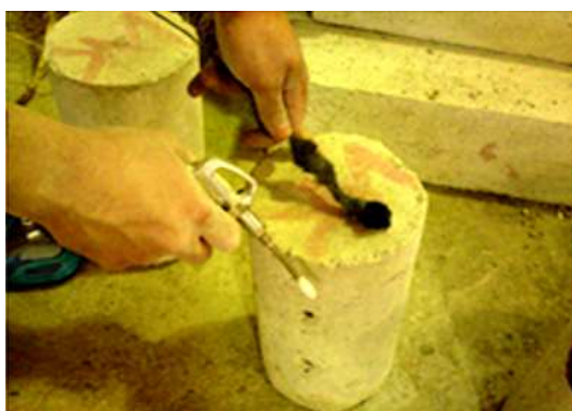
شکل ۵: تمیز کردن سوراخ توسط پمپ باد
