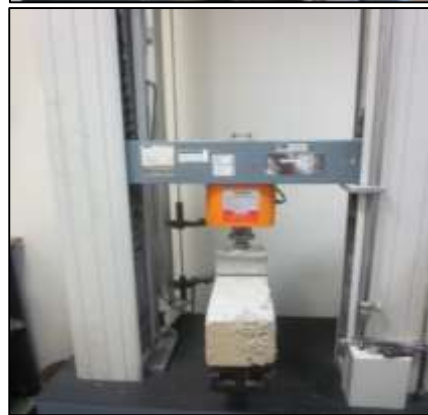
شکل ۶: دستگاه آزمون خمش سه نقطه و نحوه شکست نمونه مورد آزمایش
