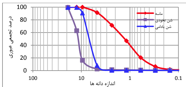
شکل ۱: منحنی‌های دانه‌بندی مصالح سنگی بکار رفته در ساخت نمونه‌ها
