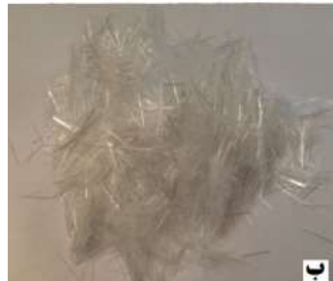
شکل ۲: الیاف فولادی (شکل الف) و الیاف شیشه (شکل ب) مورد استفاده در تحقیق
