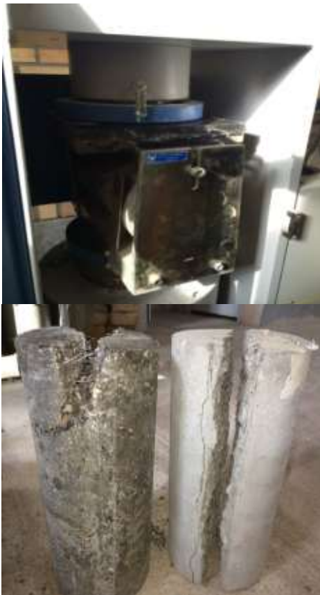
شکل ۵: آزمایش مقاومت کششی به روش دونیم شدن و شکل نهایی شکست کششی نمونه‌ها
