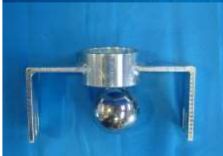
شکل ۷: دستگاه تست ضربه، نمونه‌ها و کلاهک فلزی
