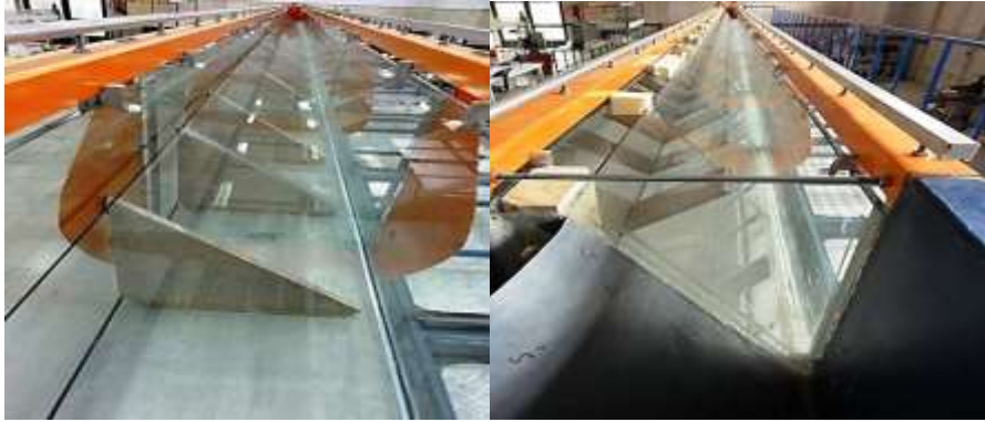
شکل 7: مقطع 30^\circ ساخته شده در آزمایشگاه.
