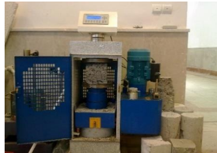
شکل 3. آزمایش مقاومت فشاری بتن متخلخل
