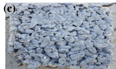
شکل 4. مقایسه ظاهر بتن متخلخل پس از آزمایش مقاومت-فشاری (به ترتیب از بالا به پایین دانه‌بندی 1-2-3)
