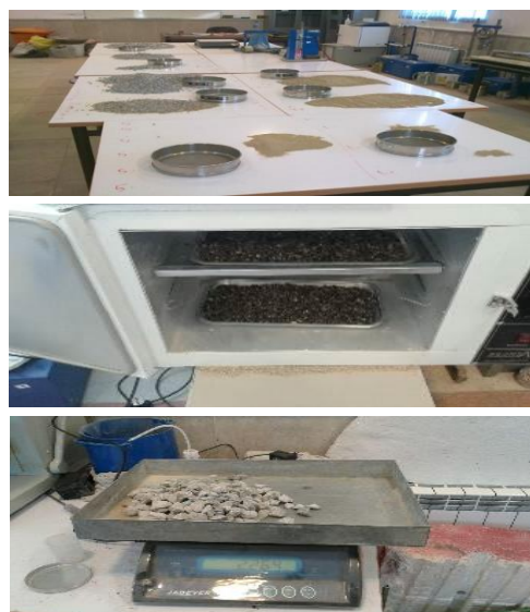
شکل 1. تفکیک سنگدانه‌ها بر اساس سایز با الک
