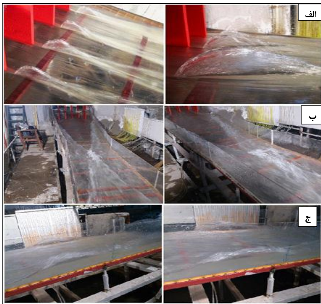
شکل ۳: امواج ایجاد شده روی مدل سرریز شوت خیرآباد (الف) موج پایه (موج ۱) (ب) موج وسط (موج ۲) (ج) موج دیواره (موج ۳)
