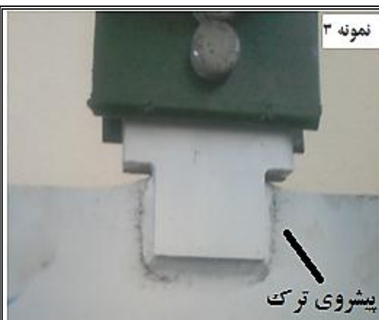
شکل ۸: پیشروی ترک در صفحه برشی (نمونه ۳) و پیشروی ترک در صفحه کششی (نمونه ۴)
