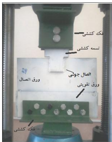
شکل ۲: فک‌های کششی و نمونه ۲ قبل از آزمایش
