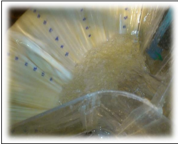
شکل ۱۱: پدیده پرش هیدرولیکی ثابت در پنجه سرریز
