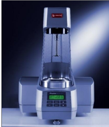
شکل ۵: رئومتر برش دینامیکی مورد استفاده
