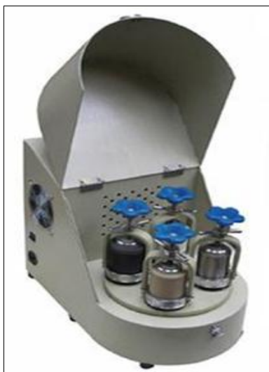
شکل ۱: آسیاب گلوله‌ای ماهواره‌ای مورد استفاده
