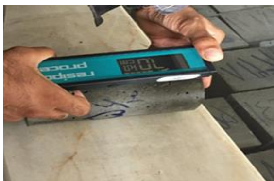
شکل 2. آزمایش مقاومت الکتریکی چهار نقطه‌ای
