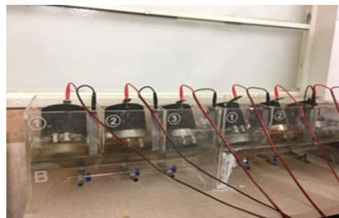
شکل 6. آزمایش نفوذ تسریع شده یون کلر (RCMT) Fig. 6. chloride ion penetration test
