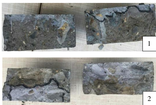
شکل 10. مقایسه میزان نفوذ یون کلر در بتن دو جزئی (سنگدانه شیشه بازیافتی) و بتن سه جزئی (سنگدانه شیشه بازیافتی و میکروسیلیس)
