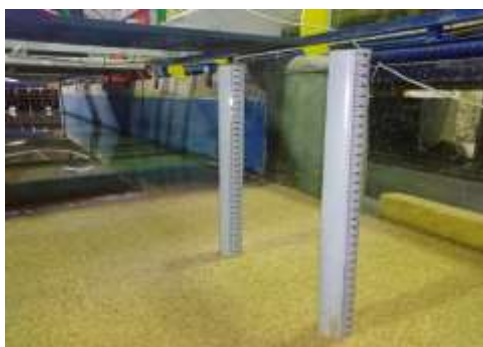
شکل ۱. پایه های پل مورد استفاده در آزمایشگاه
