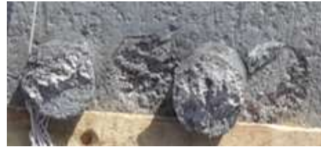
شکل 3. آزمون پیچش و خرابی جزئی حاصل از انجام آزمون "پیچش".
