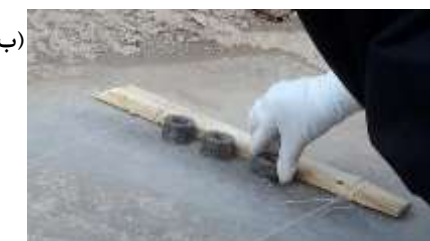
شکل ۲. (الف) چسباندن چسب به استوانه فلزی. (ب) چسباندن استوانه فلزی به سطح بتن.
