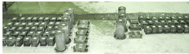
شکل ۲: ساخت انواع نمونه‌های مکعبی، منشوری و استوانه‌ای
