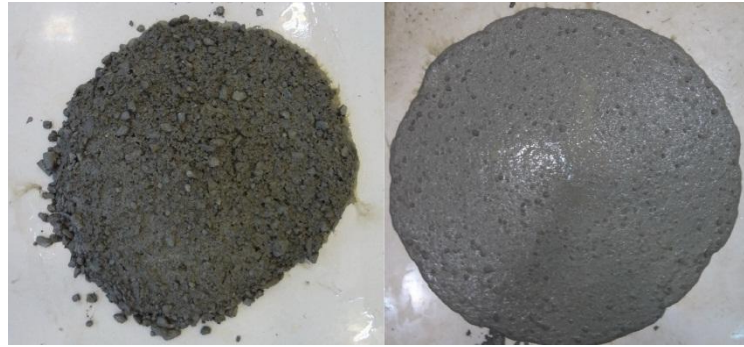
شکل ۶: نمونه سمت راست جریان اسلامپ با خمیر کافی و نمونه سمت چپ جریان اسلامپ با خمیر ناکافی
